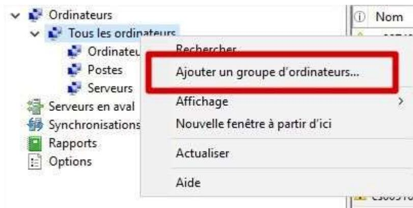
Pour que les postes soient classés automatiquement on va s'appuyer sur des GPO. La première étape est d'activer ce paramètre dans les options du WSUS
